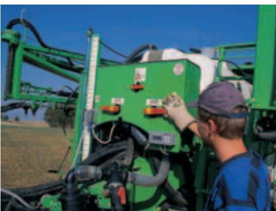
An der Stirnseite sind die Stellhähne für die beiden Pumpen (rechts und links) sowie vom Rührwerk montiert.
