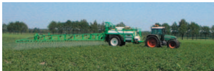
CHD Feldspritze mit 5.600 Liter Behälter mit 45 Meter Gestänge, für weitere Informationen besuchen Sie bitte unsere Internetseite: www.chdeefing.com
